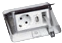
6 540 00 felszerelve 1 x 2P+F dugaljjal, 1 x USB és 1 x RJ45 csatlakozóaljzattal
