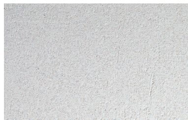
Finoman pórusos belső anyagszerkezet: természetes belső oldali hőszigetelés.
