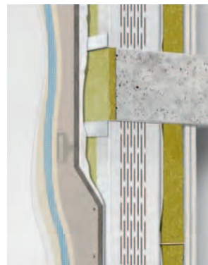
Födémre állított szerkezet perforált profilú vázzal
